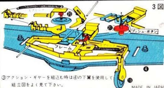
③アクション・ギヤーを組込む時は④の下翼を使用して組立図をよく見て下さい。
