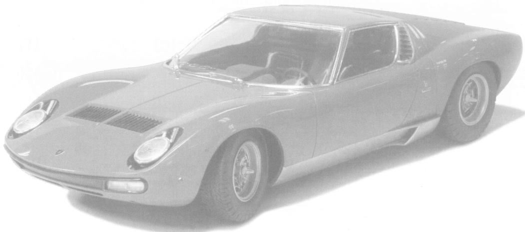
ランボルギーニ・ミウラは1966年3月のジュネーブショーで正式発表されました。車名はスペインでもっとも勇敢な闘牛の名を冠して"ミウラ"と名付けられ、全高わずか1,080mm、前後のカウルがレーシングカーの様に開閉し、ヘッドライトはポップアップ式で睫毛のような飾りがミウラのアイデンティティとなりました。ミウラの開発は非常に難航し、横置きミッドシップエンジンは信頼性不足で後輪への荷重が高く、シャシー剛性が不足し、ハンドリング上の欠点も明らかでした。ギアボックスのトラブルや車内の振動・騒音など、問題山積。しかし正式発表以降、ミウラの評判は急上昇でした。
