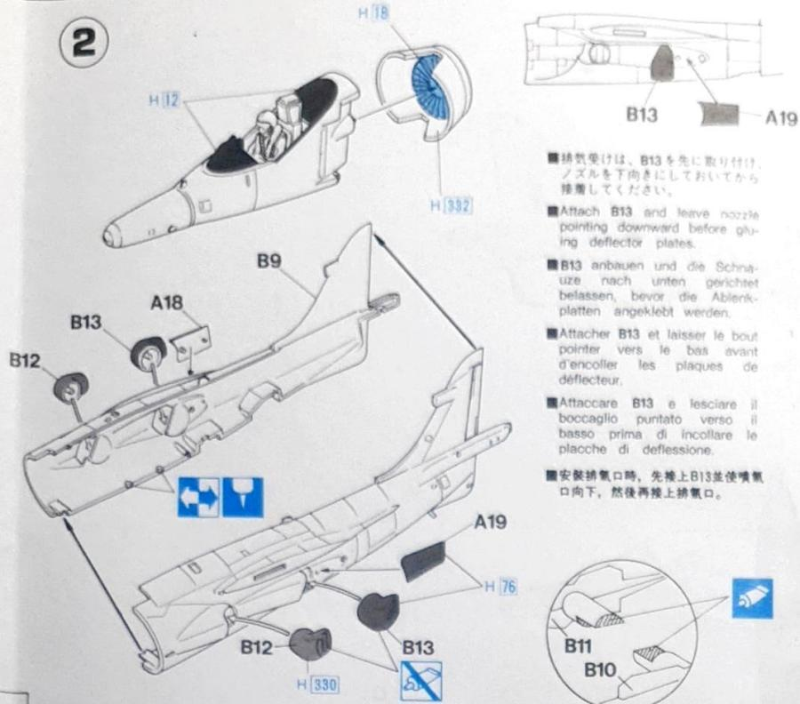
■ 排氣突げは、B13を先に取り付け、ノズルを下向きにしておいてから接着してください。
