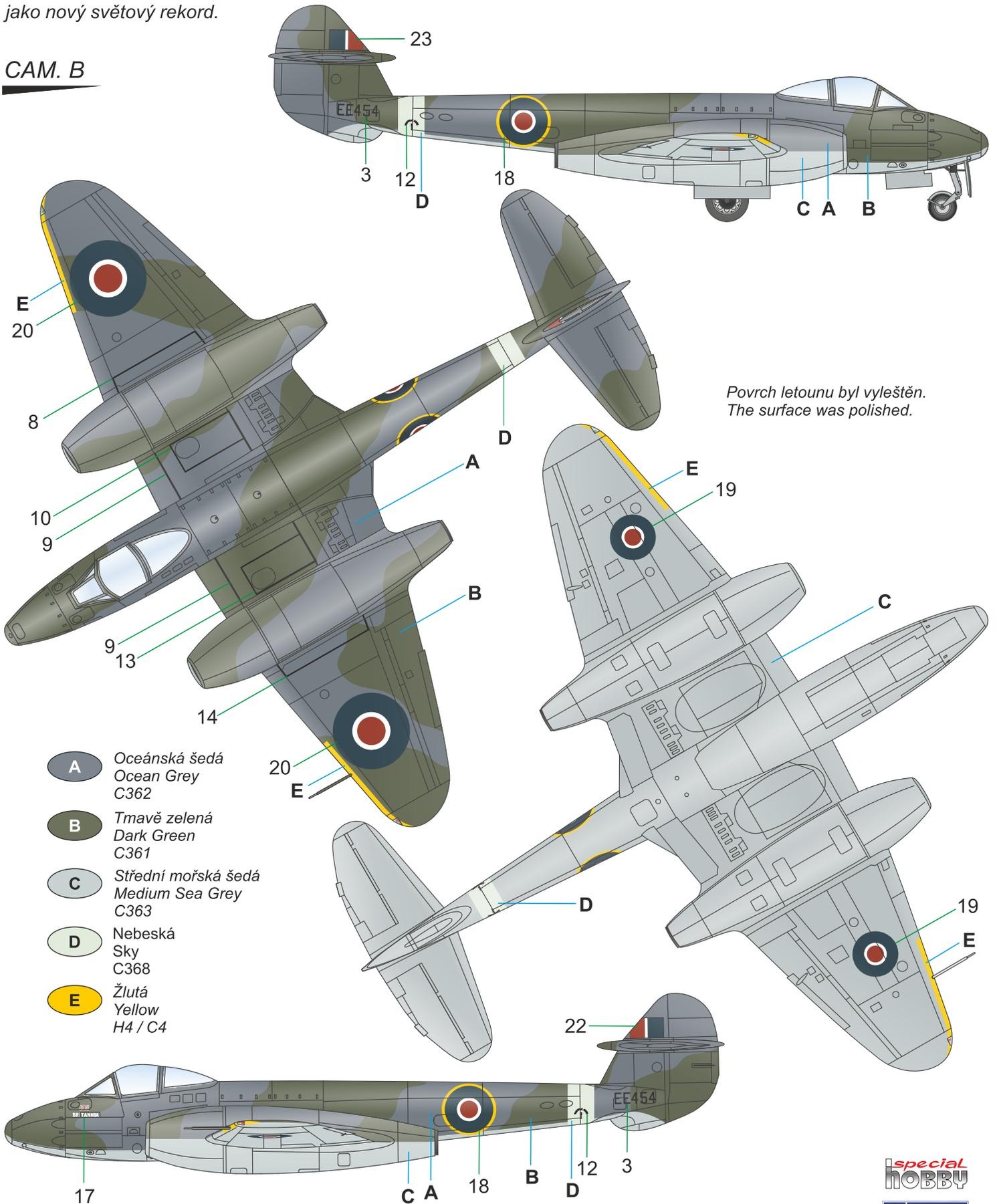
Gloster Meteor EE549, verze F Mk.4 (upravená rychlostní verze Star Meteor), RAF High Speed Flight. V kabině tohoto stroje Gp Capt. E.M. Donaldson 7. září 1946 překonal rychlost 990 km/h (616 mph). Pro rekordní let byla namontována plechem zesílená kabina, která měla eliminovat aerodynamický ohřev překrytu.
