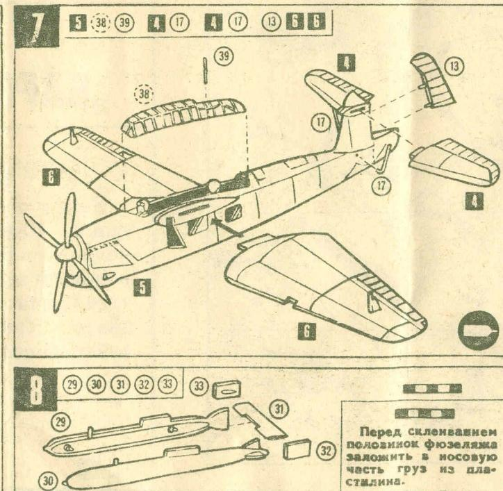
Перед склеиванием полозинок фюзеляжа заложить в носовую часть груз из пластилина.
