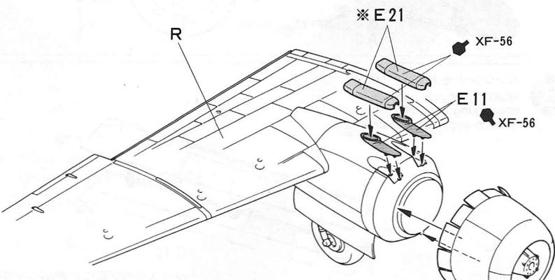
※E21の消炎排出管は夜間飛行タイプを作る時、取り付けます。
