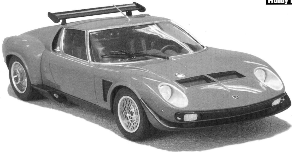
ランボルギーニ・ミウラは1966年3月のジュネーブショーで正式発表されました。車名はスペインでもっとも勇敢な闘牛の名を冠して“ミウラ”と名付けられ、全高わずか1,080mm、前後のカウルがレーシングカーの様に開閉し、ヘッドライトはポップアップ式で睫毛のような飾りがミウラのアイデンティティとなりました。ミウラの開発は非常に難航し、横置きミッドシップエンジンは信頼性不足で後輪への荷重が高く、シャシー剛性が不足し、ハンドリング上の欠点も明らかでした。ギアボックスのトラブルや車内の振動・騒音など、問題山積。しかし正式発表以降、ミウラの評判は急上昇でした。
