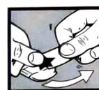
Anweisungen für Abziehbilder-Anbringung: Die benötigten Abziehbilder vom Blatt abscheiden, in ein Glas reines Wasser für etwa 10" sintauchen, auf das Modell legen und dann vom Papierbogen abnehmen. Um eine bessere Haftung zu erzielen, die Abziehbilder mit einem reinen Tuch andrücken.
