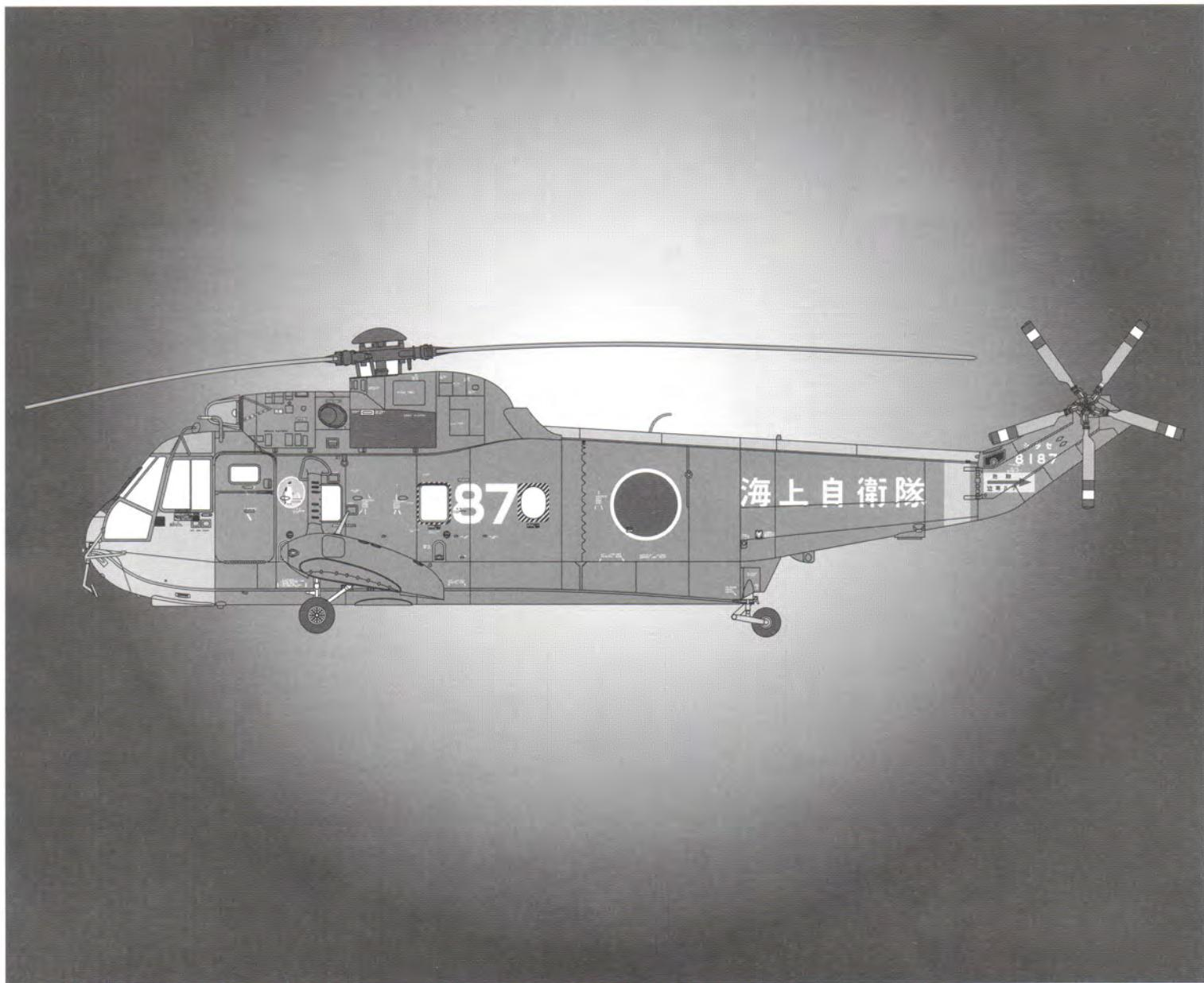
海上自衛隊では当初 HSS-2 を使用していましたが、その後搭載機器を近代化した HSS-2B に変更されました。南極観測支援用の機体 S-61 はシリアル No.8181～8185 の5機が用意されました。8181、8182 号機は比較的早くに退役し、8183、8184 号機が耐用年数を迎えたため、HSS-2B の中から飛行時間の短い2機が哨戒機器を撤去し、S-61 仕様に改造され 8186、8187 号機となりました。南極での活動において視認性を高めるための黒と蛍光オレ
