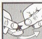
Anweisungen für Abziehbilder-Anbringung: Die benötigten Abziehbilder vom Blatt abscheiden, in ein Glas reines Wasser für etwa 20° eintauchen, auf das Modell legen und dann vom Papierbogen abnehmen. Um eine bessere Haftung zu erzielen, die Abziehbilder mit einem reinen Tuch andrücken.
