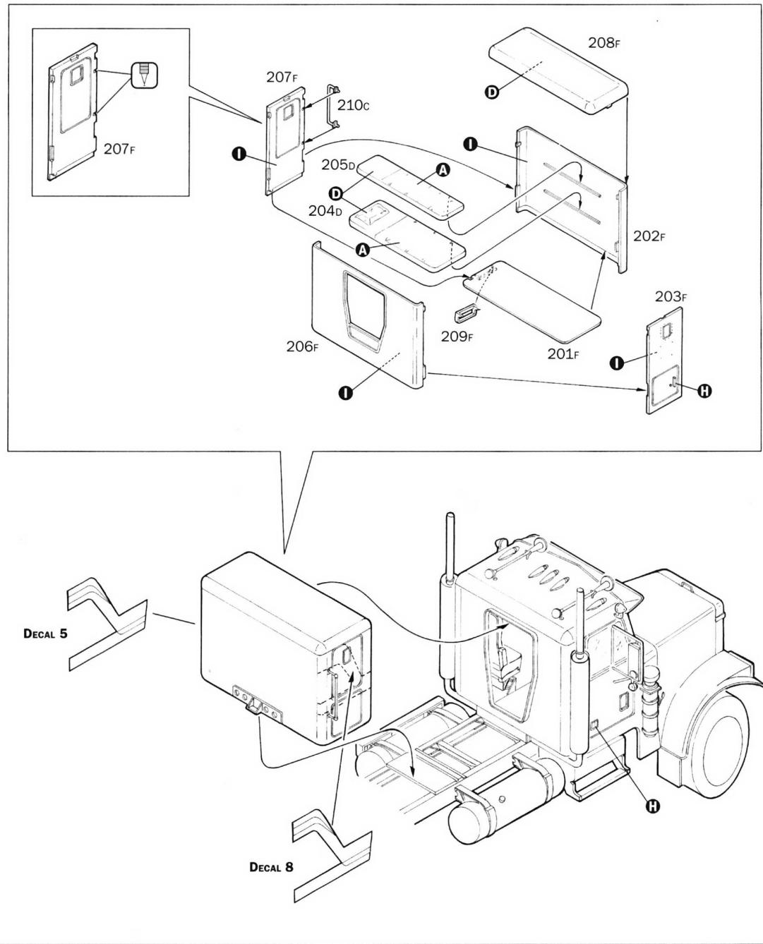
Istruzioni per l'applicazione delle decalcomanie. Ritagliare le decalcomanie occorrenti dal foglio, immergerle in un bicchiere di acqua pulita per circa 10", metterle in posizione sul modello e farle scivolare dalla carta: per una migliore aderenza comprimerle con una pezzuola pulita.
