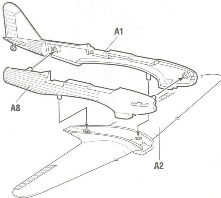
Для более надежного соединения деталей вы можете использовать клей для пластиковых моделей.
