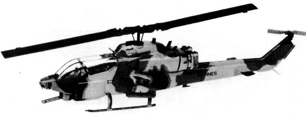
**AH-1 W SUPER COBRA** Migliorando il disegno e le prestazioni dell'elicottero da combattimento Bell AH 1 – Huey Cobra che venne usato in numeri elevati dai U.S. Marines durante la guerra di Vietnam, la Bell Helicopter Company presentava nel 1985 il tipo AH-1 W Super Cobra. Le prime consegne raggiungevano gli U.S.-Marines nel 1986. L'armamento consiste in un cannone da 20 mm high speed e alternativamente dei seguenti missili: Tow, Sidewinder, Hellfire, Zuni e 70 mm Rocket.
