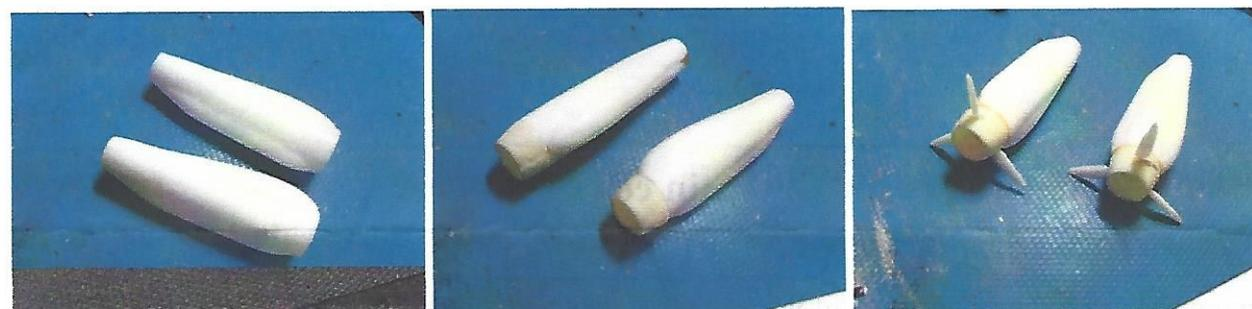
Bild links (picture on the left): Triebwerkshälften (je 2) zusammenkleben. // Please connect the engine parts (2 each).
