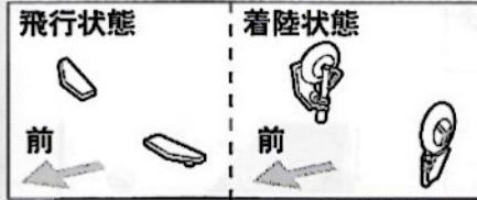
着陸状態・飛行状態にあわせて機体に脚とカバーを付けます。
