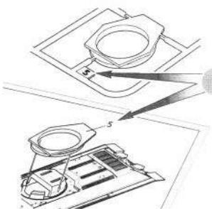
1 Прежде, чем отрезать деталь от литниковой рамки, сверьте её номер с инструкцией.
