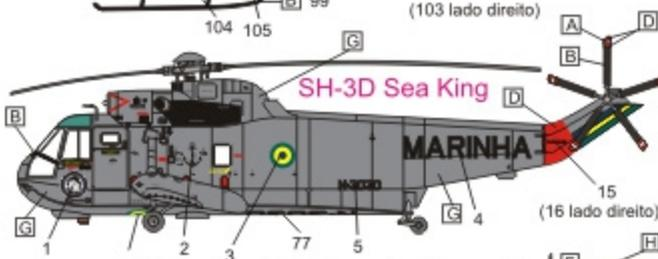
Deve ser eliminada a janela central do lado esquerdo, sob o suporte do flutuador. O 3030 não possui proteção na entrada de ar da turbina.
