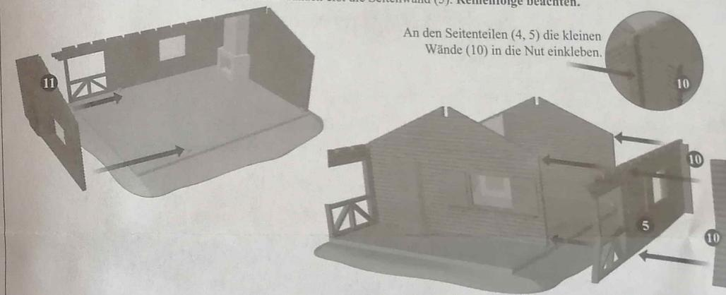
An den Seitenteilen (4, 5) die kleinen Wände (10) in die Nut einkleben.
