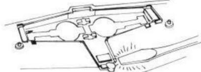
5 翼カバーをフレームに取付けます。シャフトはピンセットで通して下さい。
