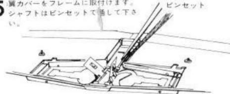
6 脚カバーをフレームに取付けます。
