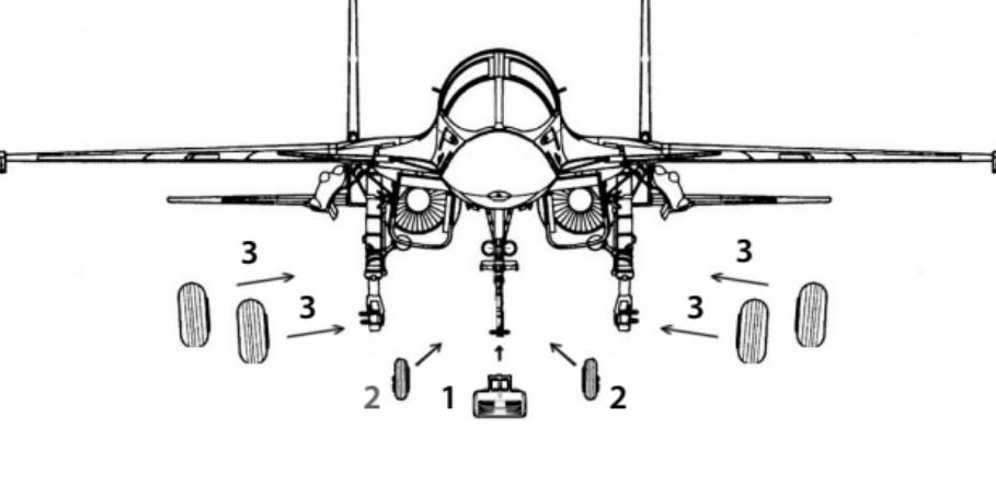
Установить вместо штатных колес набора, при необходимости расширить посадочные места колес при помощи мини-сверла/ Install instead of the standard set wheels, if necessary expand wheel seats with a mini drill
