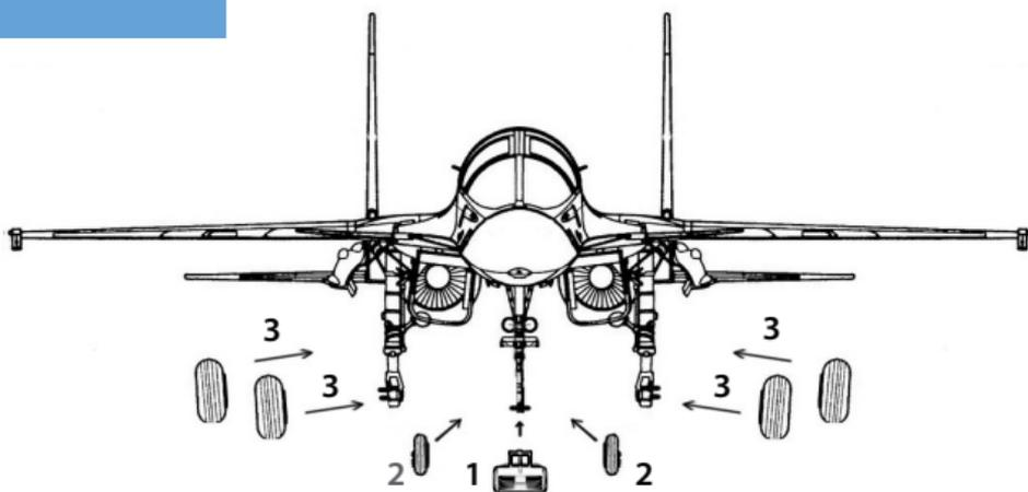
Установить вместо штатных колес набора, при необходимости расширить посадочные места колес при помощи мини-сверла/ Install instead of the standard set wheels, if necessary expand wheel seats with a mini drill
