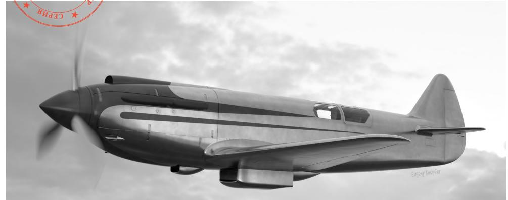
СК-1 - экспериментальный скоростной самолет, разработанный конструктором Матусом Рувимовичем Бисноват, проектировался с 1938 г. для исследования в полете крыльев с различными профилями и динамических свойств самолета при больших нагрузках на крыло, для достижения максимальных скоростей полета порядка 700-800 км/ч.
